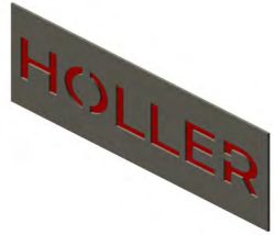
Laserski izrezan otvor s pozadinom u boji
